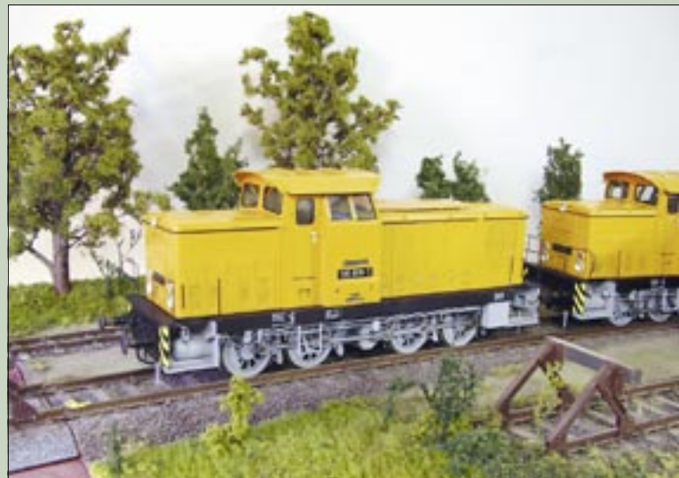
Die V 60 (BR 105, 106): Dieselhydraulischer Kraftprotz. Einst auf jedem Rangierbahnhof der DR zu Hause. Typisch waren die Zusatzschilder mit den Rufnamen für den Rangierfunk, wie „Renate 3“ oder „Rudi 5“.
